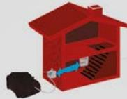
Prise de recharge extérieure sur le mur d'un bâtiment à 15m maximum du tableau électrique existant qui est placé dans le même bâtiment.
